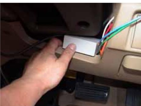
ハンドル下の隙間にコントローラを押し込み、
