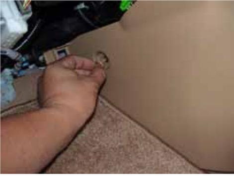
センターコンソール下部 左パネルを外し、ECUを確認します。
