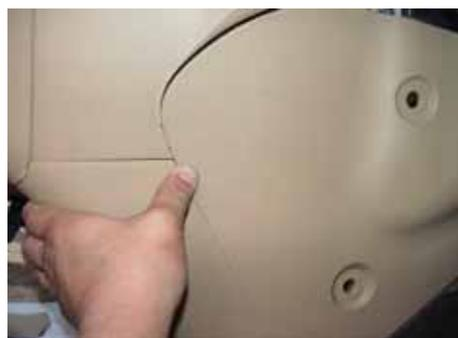
取り付けと逆の順序でパネルを戻していきます。
