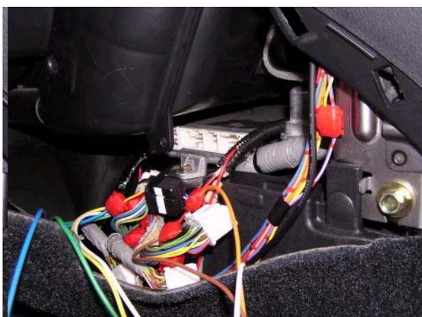
カーペットをめくりECUが見えたら、カブラを引き抜きます。
